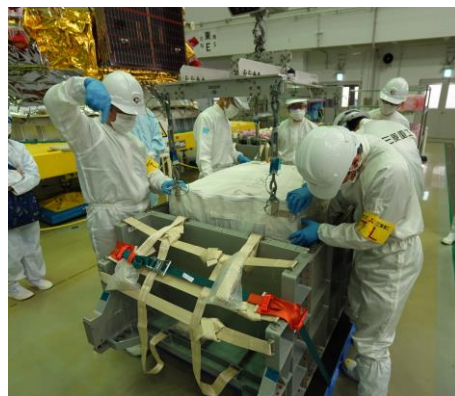
カーゴ搭載ラック(HRR)への カーゴ積み付け作業
