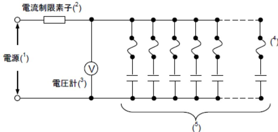
図 L-2 電圧エージングの試験回路
